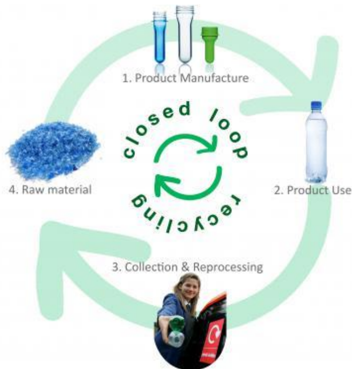
Abbildung 4 Darstellung des „Closed Loop“ beim Recycling von PET 1. „Preform“ der PET-Flasche, wird noch zu handelsüblicher PET-Flasche aufgeblasen 2. Verwendung der PET-Flasche 3. Rücknahme der verwendeten PET-Flaschen und Wiederverwertung 4. Recycling zum Rohmaterial (PET-Flakes)
