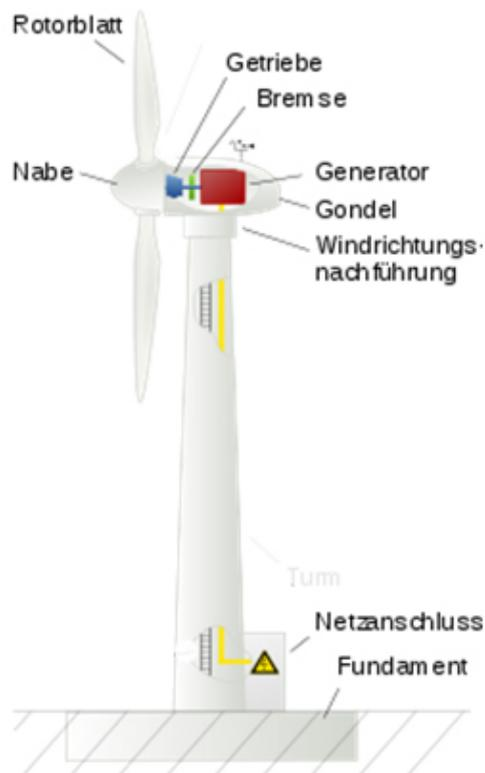
Abbildung 4.9: Aufbau eines Windrads nach aktuellen Standards, [42].
