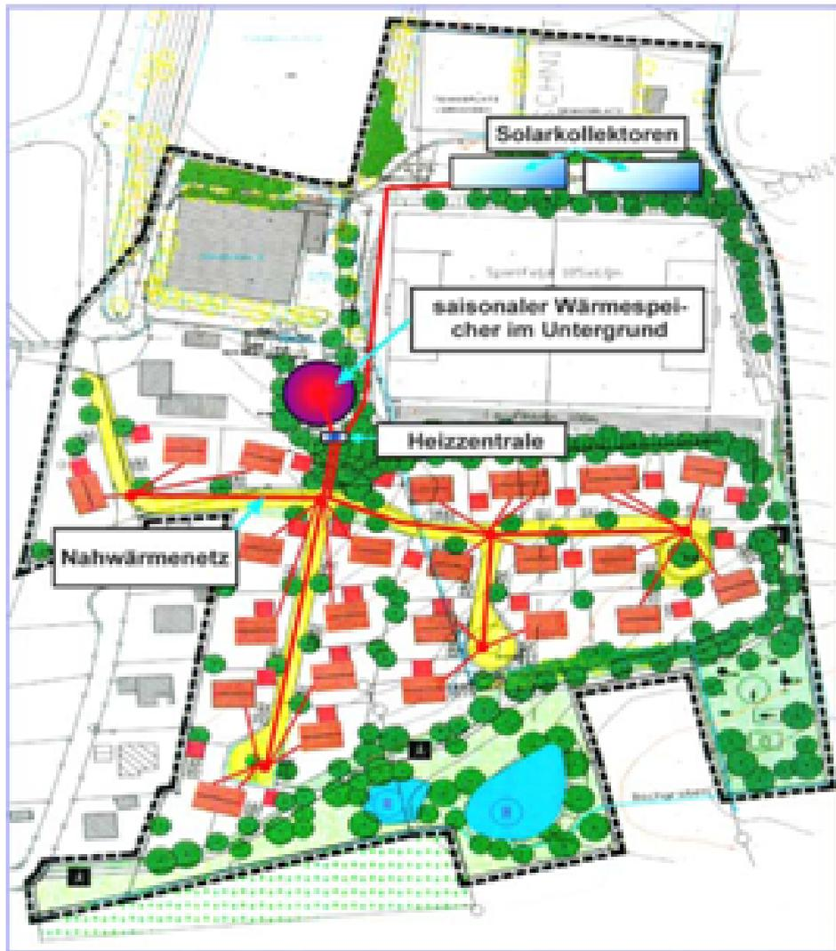
Abbildung 4.32: Lageplan der solaren Nahwärmeversorgung Attenkirchen [103].
