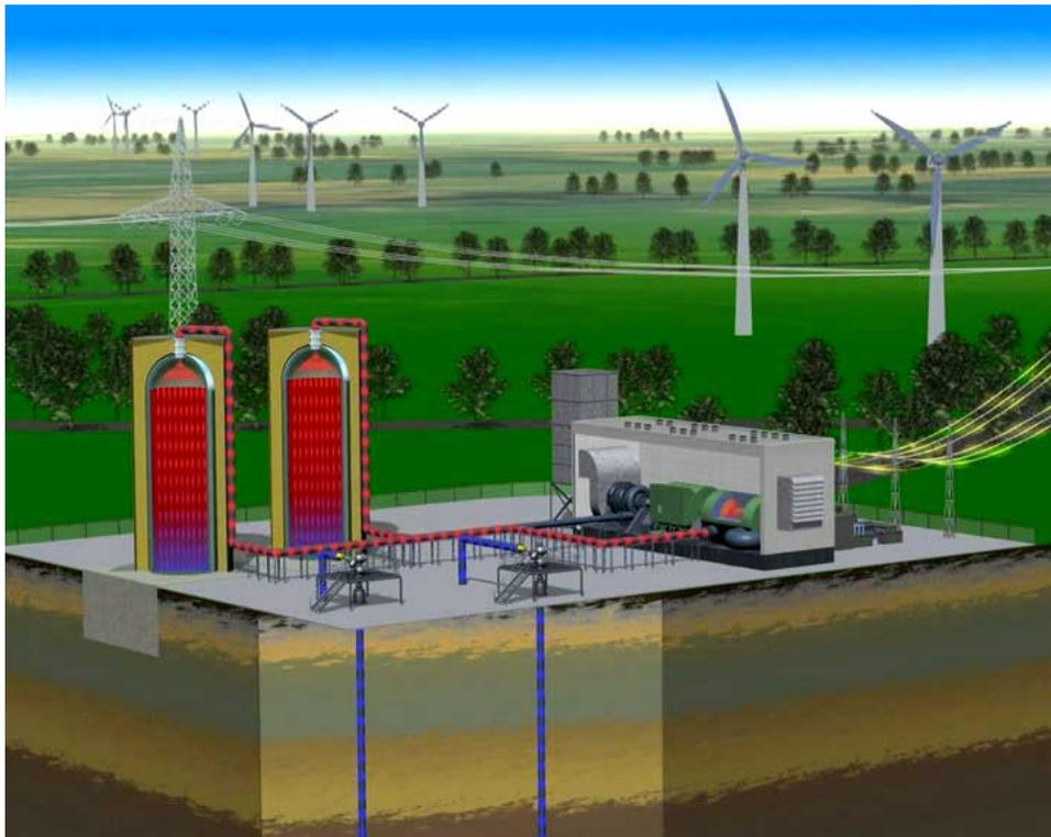
Abbildung 4.34: ADELE: Adiabater Druckluftspeicher zur elektrischen Energiespeicherung im Netzmaßstab. Derzeit wird eine erste Testanlage entwickelt [108].
