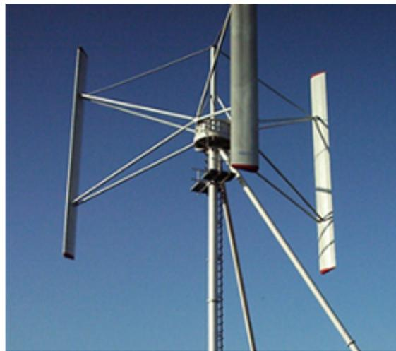
Abbildung 4.11: Modell einer modernen Kleinwindanlage, [45].
